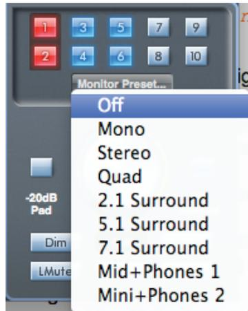
Une gamme de configurations d'écoute pré-réglées est fournie ; cliquez sur le bouton **Monitor Preset...** pour ouvrir une liste déroulante. Ces presets permettent une sélection simple des configurations d'écoute de contrôle courantes. Pour que les presets d'écoute fonctionnent correctement, vos enceintes doivent être connectées aux sorties ligne comme indiqué dans le tableau en page 17.
