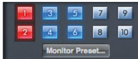
Ces boutons déterminent quelles sorties lignes de la Scarlett 18i20 sont affectées par les autres commandes de la section Monitor de l'interface graphique utilisateur, et également par les commandes d'écoute de la face avant. Selon votre configuration d'écoute de contrôle, vous pouvez ne piloter aucune enceinte, une seule paire d'enceintes ou jusqu'à 10 enceintes simultanément.
