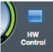
Cliquer sur ce bouton transfère le contrôle du niveau d'écoute général entre Scarlett MixControl et la commande VOLUME MONITOR de la face avant de la Scarlett 18i20. Quand il est enclenché, ce bouton est bleu et c'est la commande d'écran qui est désactivée.
